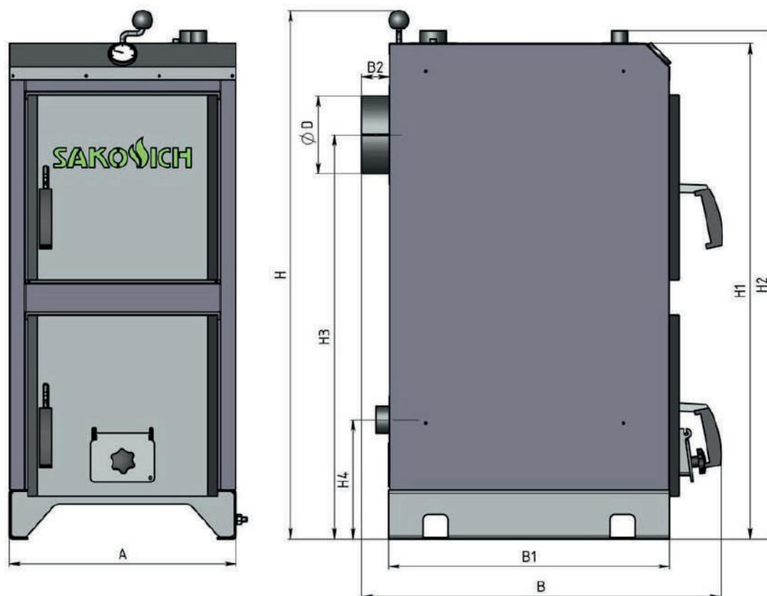
Рис. 1. Разрез и размеры котла SAKOVICH STANDART PRO
