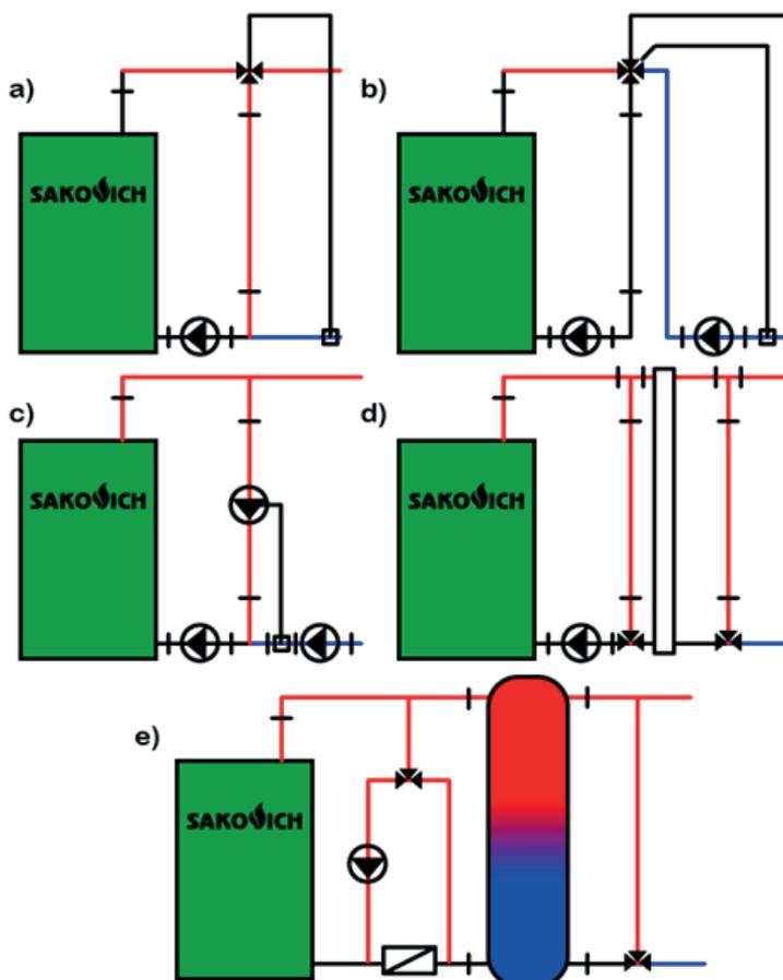
Рис 3. Рекомендуемые схемы соединения котла с системой отопления:
