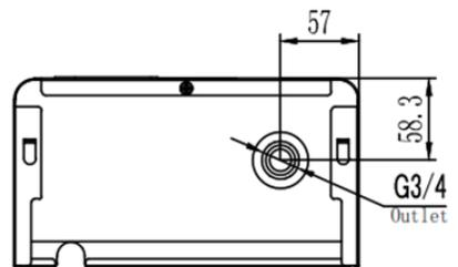
**Рисунок 4.3. Габаритные размеры для подключения к системе отопления ES-15, ES-18.**
