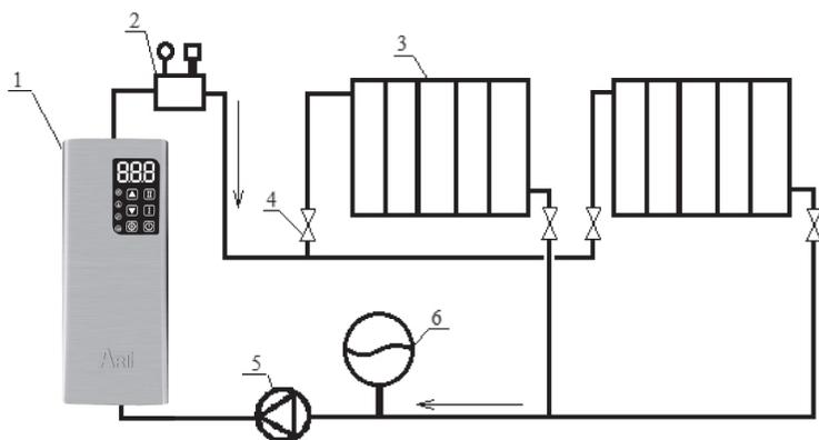
**Рисунок 7.2.** Примерная схема двухтрубной системы отопления с принудительной циркуляцией.
