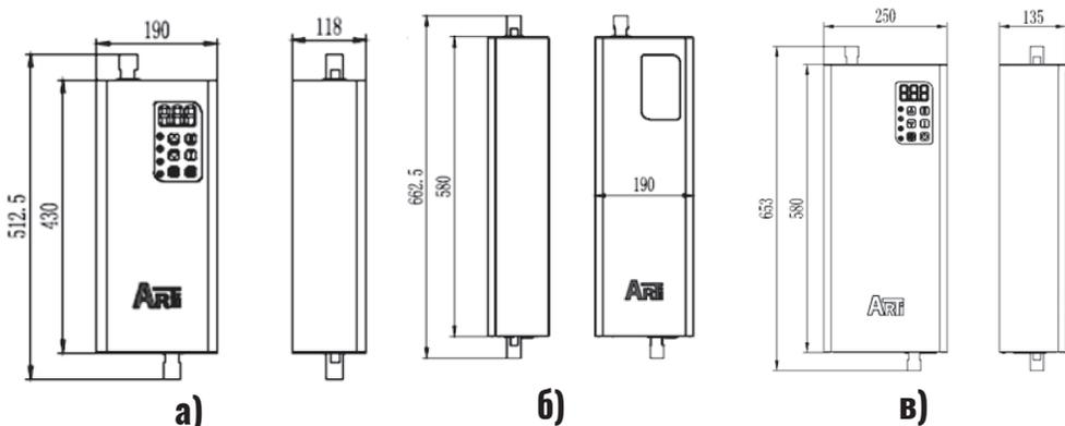
**Рисунок 2. Габаритные размеры.**
