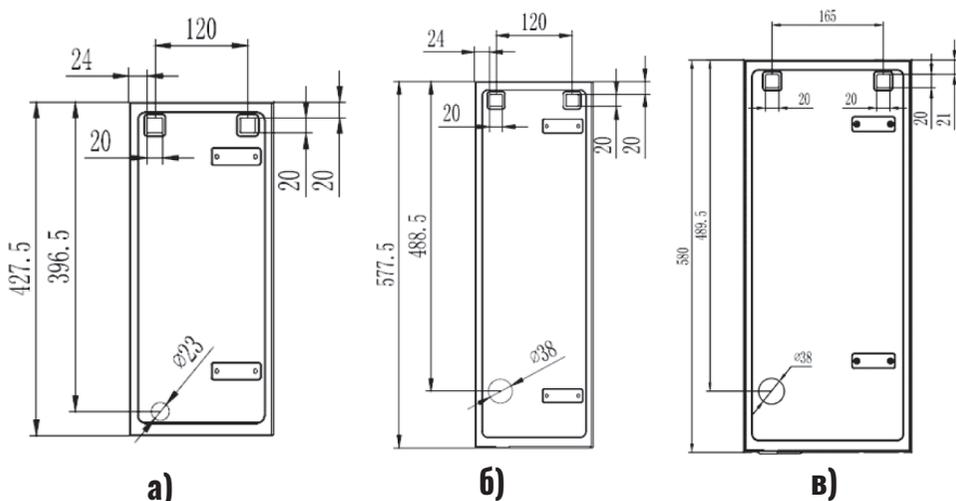
**Рисунок 3. Монтажные размеры для крепления на стены.**
