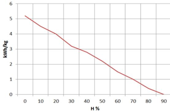
Figure n°6 - Rapport entre humidité et pouvoir calorifique du bois.
