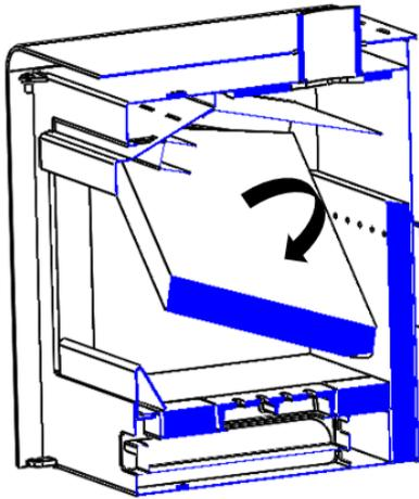
Figure n°9 - Extraction des déflecteurs en vermiculite
