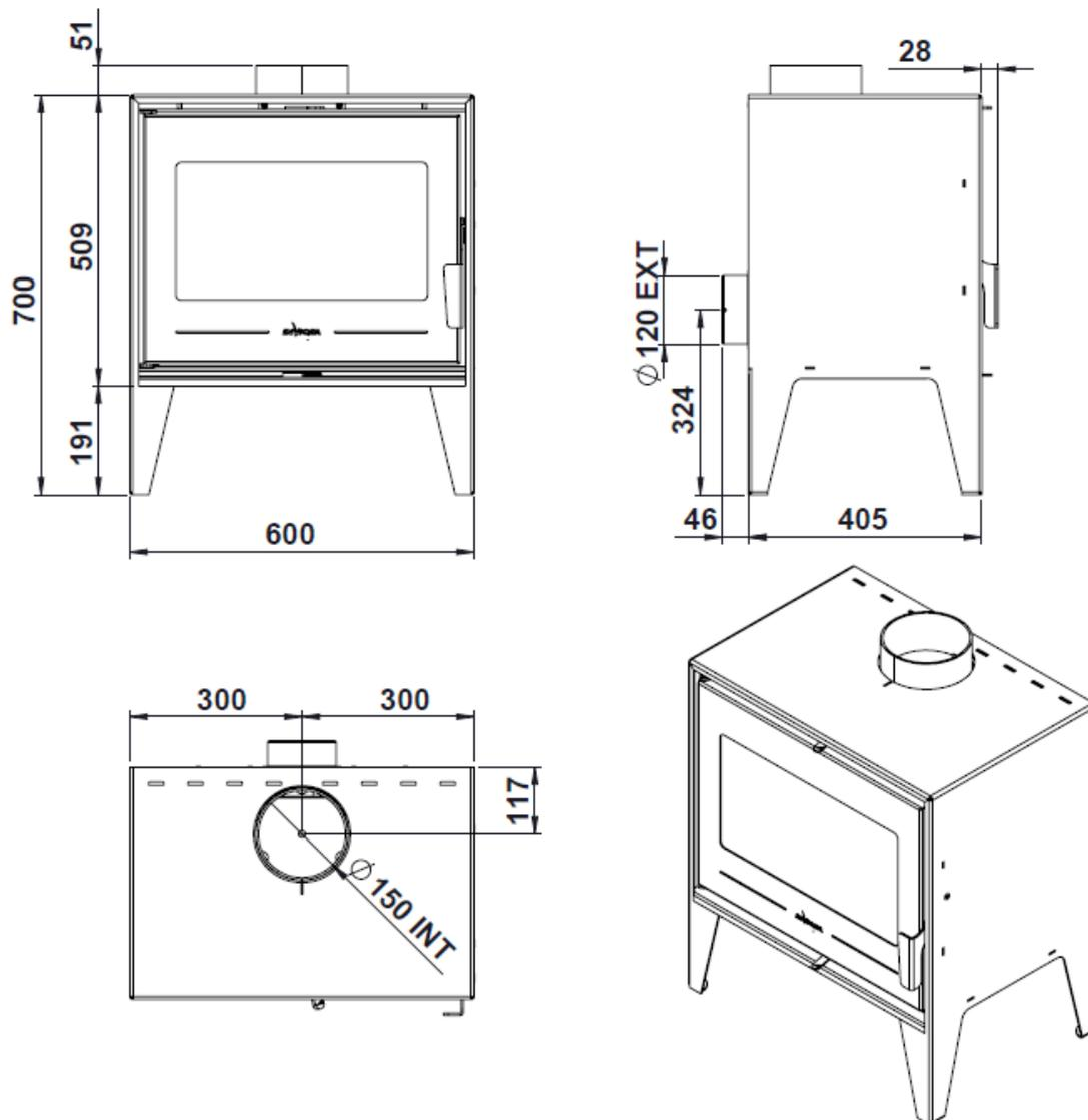
Figure n°1 - Dimensions en mm de l'appareil Euros
